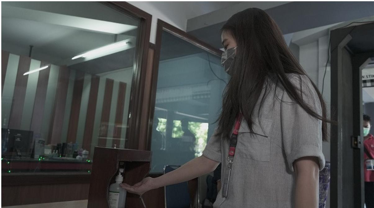
Ia juga menambahkan nantinya alat ini akan ada pengembangan, yakni mengganti papan kayu dengan bahan akrilik. Untuk sensor infrared akan diganti menggunakan sensor ultrasonik, dikarenakan sensor infrared terkadang kurang normal saat digunakan di tempat yang terdapat banyak pantulan cahaya
